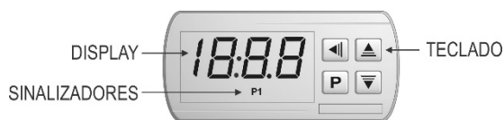
Figura 8 – Painel frontal do controlador
