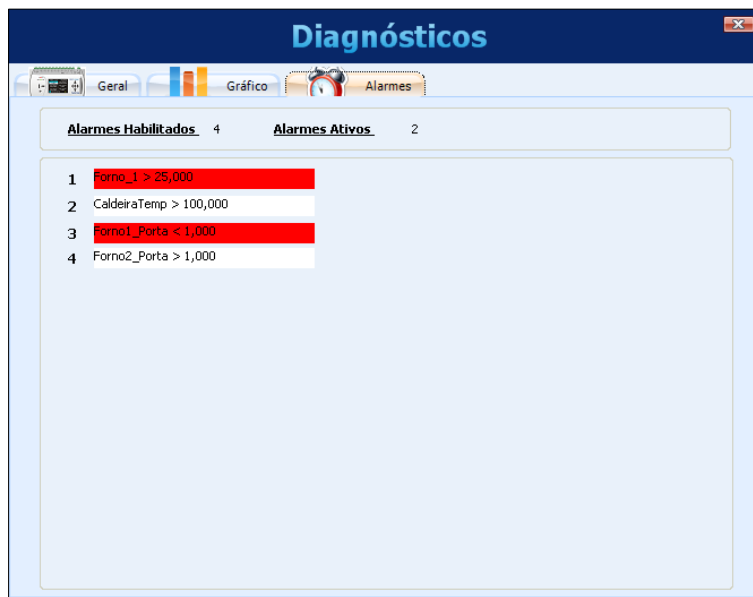
Figura 73 – Diagnósticos – Monitorando alarmes
