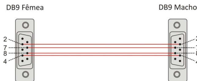
Figura 112 – Confeção do cabo de extensão
