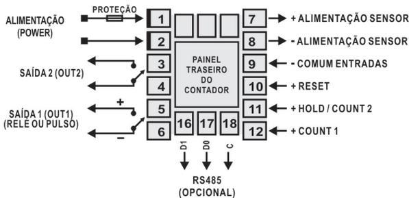
Figura 6 – Conexões elétricas traseiras do NC400-6
