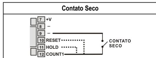
Figura 7b – Formas de ligação de sinais às entradas do NC400-6
